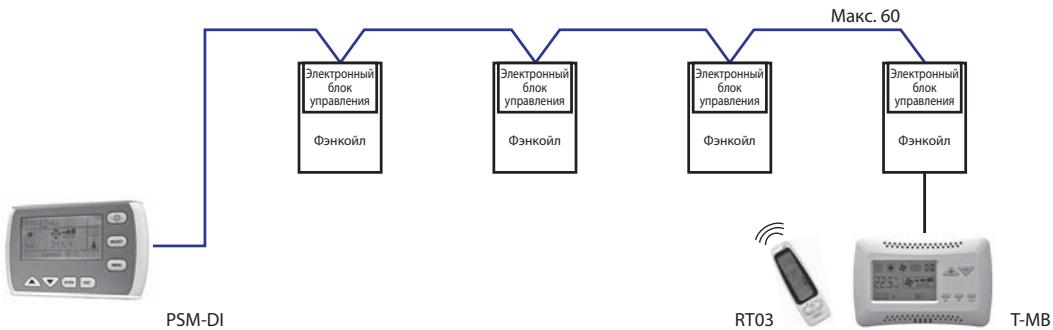
Каждый фэнкойл должен быть оснащен электронным блоком МВ.
