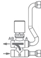
**V2300PA A** – клапан 3-х ходовой для основного теплообменника SFHO (типоразмер 1) и дополнительного теплообменника 4-х трубных SFHO (типоразмер 1-3).
