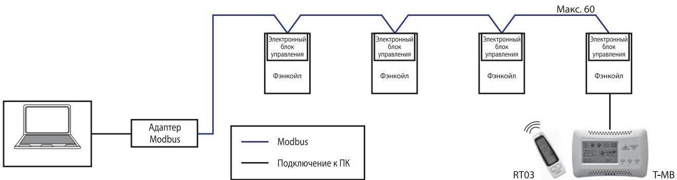
Каждый фэнкойл должен быть оснащен электронным блоком МВ.
