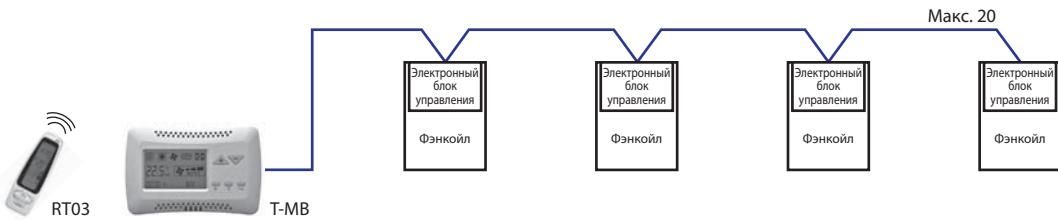
Каждый фэнкойл должен быть оснащен электронным блоком MB.
