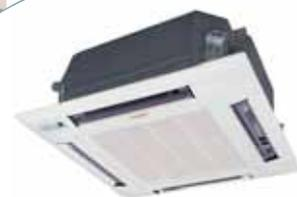
Кассетные четырехпоточные внутренние блоки представлены в компактном (650×650 мм) и стандартном (950×950 мм) исполнениях. Блоки устанавливаются в подвесной потолок и обеспечивают равномерное охлаждение/обогрев помещения за счет подачи воздуха в четырех направлениях. Небольшая высота (от 230 мм) и встроенный насос для отвода конденсата облегчают установку кассетных блоков.
