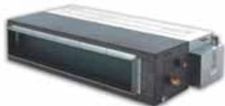
Канальные внутренние блоки в тонком и стандартном исполнении устанавливаются в подвесной потолок. Небольшая высота и насос для подъема отводимого конденсата облегчают монтаж. Благодаря пластиковому кожуху вентилятора и специальной геометрии его лопастей канальные блоки обладают низким уровнем шума.
