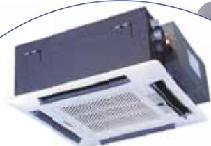
Компактные кассетные внутренние блоки предназначены для монтажа в подвесной потолок. Блок закрывается декоративной панелью размером 650×650 мм, которая является видимой частью кондиционера. Несмотря на компактные размеры, кассетные сплит-системы обеспечивают равномерный воздухообмен в помещении за счет четырех рядов распределительных жалюзи. Предусмотрена возможность подсоединения воздуховода для подмеса свежего воздуха в количестве 10% от общего объема рециркулируемого воздуха.
