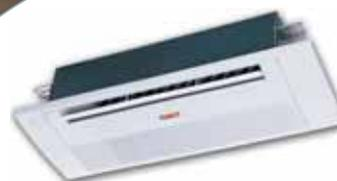
Кассетные однопоточные внутренние блоки высотой всего 185 мм монтируются в подвесной потолок с расстоянием между подвесным и основным потолком 190 мм. Насос отвода конденсата входит в комплект поставки и обеспечивает подъем конденсата на 700 мм. Однопоточные блоки устанавливаются в помещениях с высотой потолков ниже 3,5 м и равномерно распределяют воздушный поток по помещению, поддерживая комфортный микроклимат.
