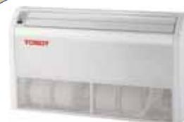
Напольно-потолочные внутренние блоки используются в помещениях сложной формы, не оборудованных подвесными потолками. При установке под потолок поток воздуха распространяется горизонтально вдоль потолка. В случае с напольной установкой воздушная масса направляется вертикально вверх вдоль стены. Компактные размеры и различные возможности монтажа делают данные сплит-системы достойной альтернативой кассетным кондиционерам.
