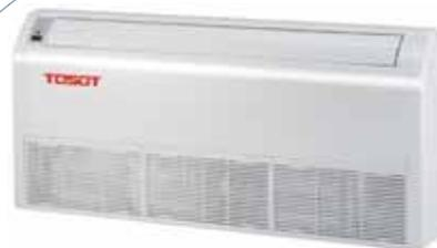
Напольно-потолочные внутренние блоки могут быть установлены в любых помещениях благодаря своим компактным размерам (глубина от 225 мм). Широкий угол подачи воздуха обеспечивает его равномерное распределение по помещению. Кондиционеры просты и удобны в обслуживании. Решетка на защелках и моющиеся фильтры легко снимаются с любой стороны.
